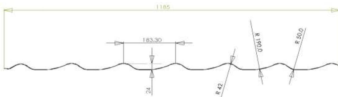
Параметры профиля: ширина полезная – 1100 мм, глубина ступеньки – 15мм («Монтеррей»), 20мм («СуперМонтеррей»)
